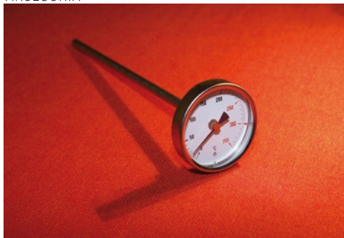
▲ Termometr do pomiaru temperatury spalin w kanale kominowym
